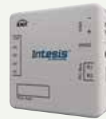
KNX-Interface für Geräte der F- und G-Generation
