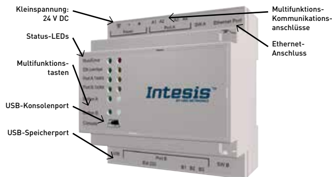
U1/U2-Kommunikationsleitung direkt mit der IntesisBox verbunden. 16 bis 128 Innengeräte pro Interface.
