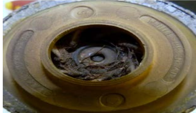
Partikelablagerungen in den Pumpen
