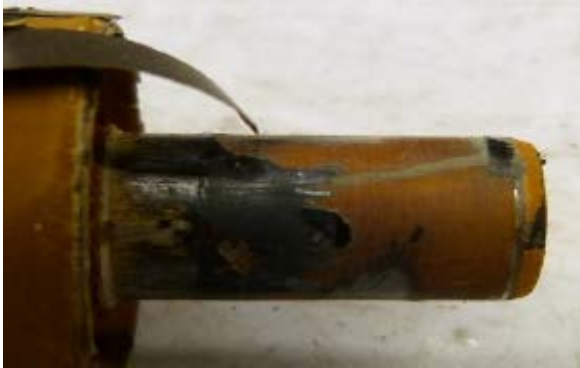
Partikelablagerungen in den Pumpen
