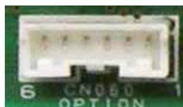
PAW-OCT : Panasonic a mis au point le PAXW-OCT, un accessoire en option (constitué d'une prise et de câbles) qui simplifie la connexion à ce connecteur optionnel (CN060).
