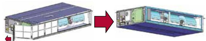
Lorsque la gaine d'entrée d'air (non fournie) est reliée au côté aspiration, retirer le filtre, le châssis et les matériaux d'isolation des deux côtés de l'unité. Raccordez la gaine sur le côté aspiration de l'unité en utilisant les trous prévus à cet effet.
