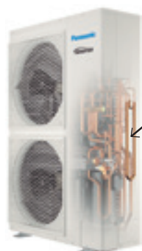
Duplacsöves hőcserélő. Alacsony nyomású és alacsony hőmérsékletű hűtőközeg a belső csőben.
