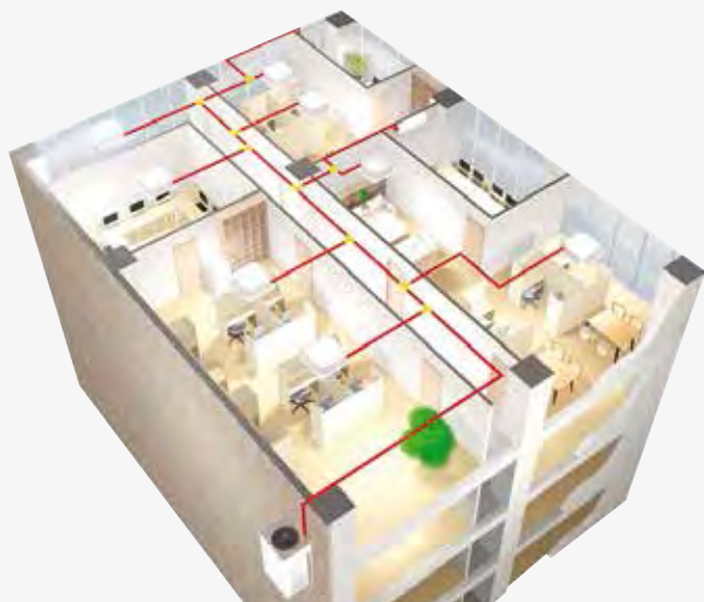
a) Lunghezza massima dei tubi tra l'unità esterna e l'unità interna più lontana (lunghezza equivalente): 190 m; (lunghezza effettiva): 165 m - b) Lunghezza massima dei tubi tra la prima deviazione e l'unità interna più lontana (lunghezza equivalente): 40 m - c) Lunghezza massima di tutti i tubi principali: 135 m
