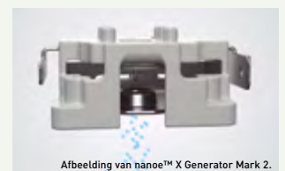
Er is geen onderhoud of vervanging vereist. nanoe™ X is een filtervrije oplossing die geen onderhoud vergt omdat de vernevelingselektrode uit titanium is vervaardigd en tijdens het generatieproces wordt omhuld door water.
