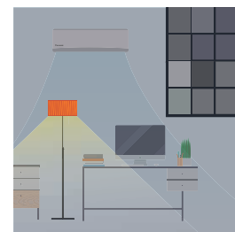
Zaznavanje sončne svetlobe Moč hlajenja prilagodi spremembam v jakosti sončne svetlobe.
