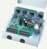
**Seriell-paralleler Schnittstellenadapter für bis zu 4 Außengeräte**
