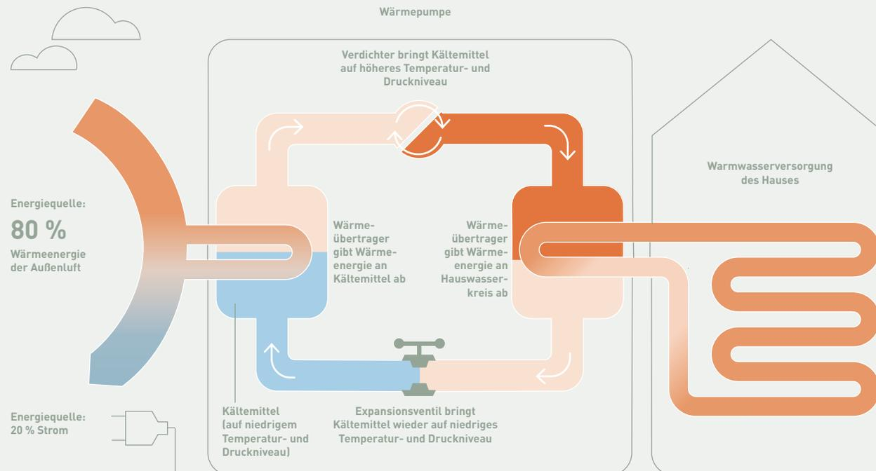
Mit Aquarea-Wärmepumpen können Sie bis zu 80 % Energie sparen. Aquarea nutzt die Wärmeenergie der Umgebungsluft als erneuerbare und kostenlose Energiequelle, um Gebäude zu erwärmen bzw. zu kühlen und Warmwasser für den sanitären Bereich zu erzeugen.
