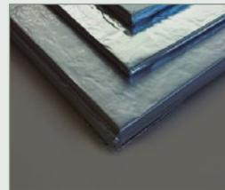
Die ultradünnen U-Vacua™-Wärmedämmplatten haben einen einzigartigen Glasfaserkern, der von einem mehrschichtigen Laminat u. a. aus Nylon, Aluminium und einer weiteren Schutzschicht umschlossen wird. Durch Senkung des Innendrucks auf 1 – 20 Pa wird das Material verdichtet und seine Wärmeleitfähigkeit minimiert.
