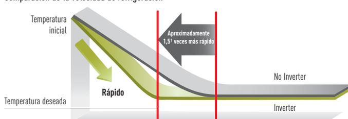
1. Inverter de 1,5 HP vs. no Inverter. Temperatura exterior: 35°C ; ajuste de la temperatura: 25°C .
