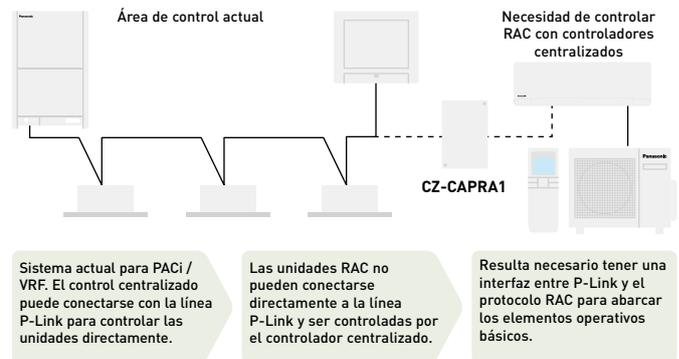
Sistema actual para PACi / VRF. El control centralizado puede conectarse con la línea P-Link para controlar las unidades directamente.
