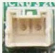
Cable para operar el ventilador EC externo.
