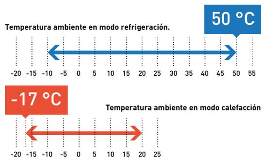
Refrigeración: Temperatura del aire exterior °C (ITS). Calefacción: Temperatura del aire exterior °C (TH).
