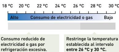
**4. Temporizador de ahorro de energía /Ajuste de funcionamiento eficiente.**
