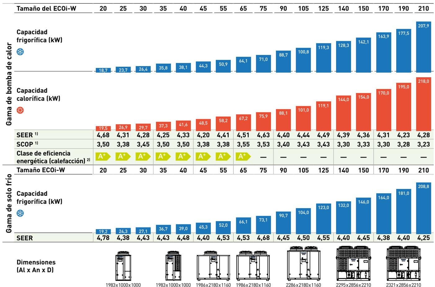
1) Estos son los datos con bomba de caudal variable. Para los datos con bomba de caudal fijo, contacta con un distribuidor autorizado de Panasonic. 2) En conformidad Eurovent y el REGLAMENTO DELEGADO (UE) n.º 811/2013 DE LA COMISIÓN para bombas de calor de baja temperatura. Escala de A+++ a D, a partir del 26 de septiembre de 2019.
