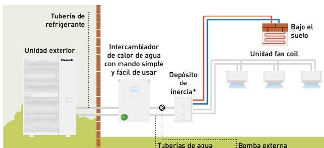
\* Volumen mínimo del depósito de inercia: 10 L/kW. \*\* El diagrama se facilita solo para fines ilustrativos.
