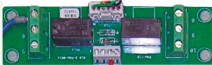
Interfaz T10 PCB con conexiones digitales y de relé.
