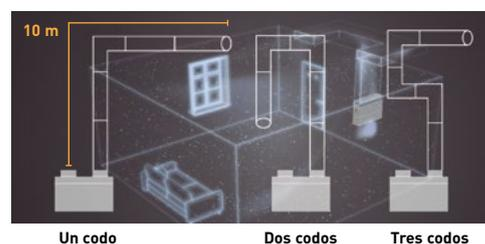
Como demuestran los ensayos, la eficacia de nanoe™ X se mantiene incluso con una longitud del conducto de 10 m.
