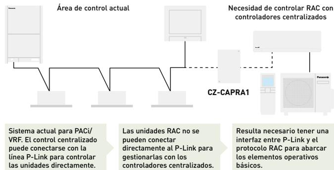
**Elementos básicos de funcionamiento:** ON/OFF, selección del modo, ajuste de temperatura, velocidad del ventilador, ajuste de la aleta, prohibición de control remoto.
