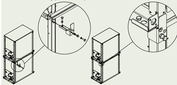
La disponibilidad de apilamiento vertical fácil permite instalaciones en un espacio limitado (hasta 3 unidades)\*. Intercambiador de calor de chapa de acero inoxidable con control de protección anticongelación. Alternancia entre funcionamiento de calefacción y refrigeración.
