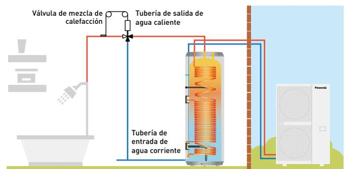
\*Hasta 65°C con compresor y hasta 85°C con resistencia
