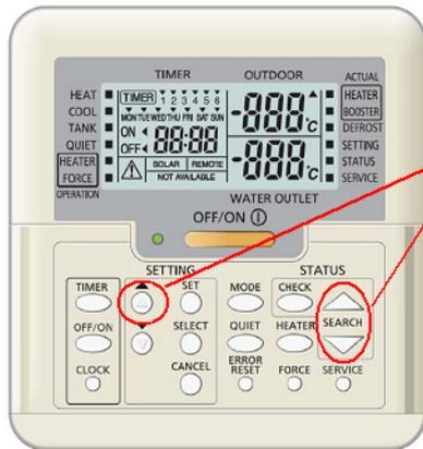
Pulse y mantenga estos 3 botones **simultáneamente** durante 5 segundos hasta que los cambios de la pantalla LCD como se muestra (a la derecha)
