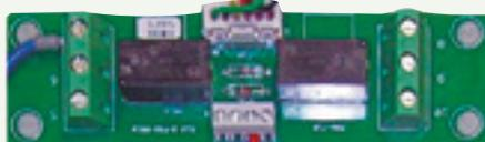
Tiskana pločica za T10 sučelje s digitalnim i relejnim spojevima.
