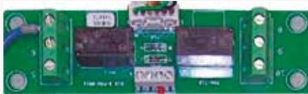
**PCB di interfaccia T10 con connessioni digitali e a relè.**
