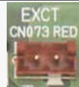
**Cavo con spegnimento forzato termostato/rilevazione perdite.**
