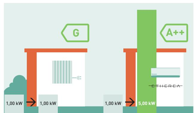
\* SCOP i oppvarmingsmodus for CS-NZ25YKE og CS-NZ35YKE sammenlignet med elektriske varmeelementer ved +7 °C.
