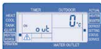
6. Utomhustemperatur där elpatronen ska kopplas på (-15 till +20°C, Std. 0°C)
