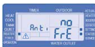
3. Frysskyddsfunktion (YES / NO, Standard: YES).
