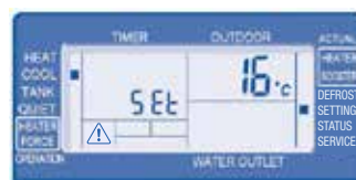
7. Vattnets börtemperatur vid kyl drift (5 till 20°C, Std. +16°C)
