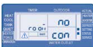
1. Anslutning av en extern rumstermostat (YES / NO, Standard: NO).
