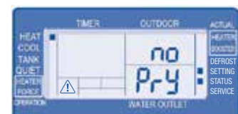
6. Företräde för uppvärmning (YES / NO, Standard: NO). Det här värdet bör behållas på NO, eftersom varmvattnet annars endast värms upp med elpatronen.
