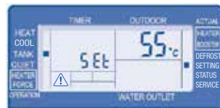
8. Varmvattenberedarens börtem- peratur (40 till 75°C, Std. +55°C)
