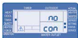
4. Anslutning av en varmvattenberedare (YES / NO, Standard: NO).
