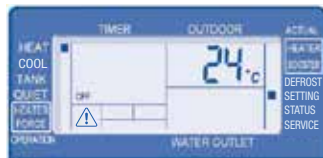
5. Börtemperaturen för avstängning av värmedrift (värmegränstempla- tur, 5 till 35°C, Std. 24°C)
