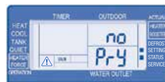
5. Företräde för solenergi (YES / NO, Standard: NO). Det här värdet bör alltid vara inställt på YES när en solenergianläggning används.
