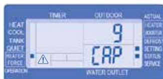
2. Val av effekt hos elpatronen i inomhusenheten (3 / 6 / 9 [beroende på storlek] Standard: maximalvärde).
