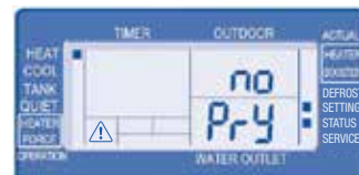
6. Företräde för uppvärmning (YES / NO, Standard: NO). Det här värdet bör behållas på NO, eftersom varmvattnet annars endast värms upp med elpatronen.
