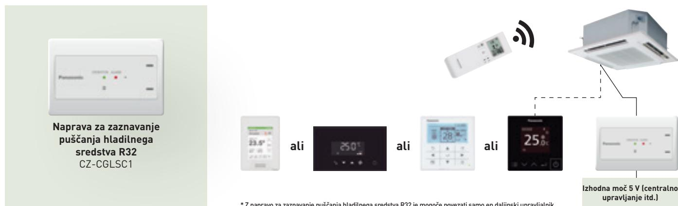
Alarm, ki ga sproži naprava za zaznavanje puščanja hladilnega sredstva R32, bo prav tako prenesen in prikazan na katerem koli priključenem centraliziranem upravljalniku.
