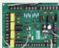
Plošča tiskanega vezja za napredne funkcije v napravah generacij J in H
